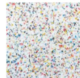
**Sas Minimum Pavé**, réalisé à partir d'une grande variété de déchets plastiques, matériau 100% recyclé et recyclable.
